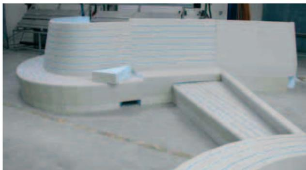
Tous les éléments porteurs de mousse dure ont été préfabriqués sur mesure dans l'usine de Lux Éléments, puis assemblés dans ses propres locaux de production afin d'en vérifier l'exactitude.
