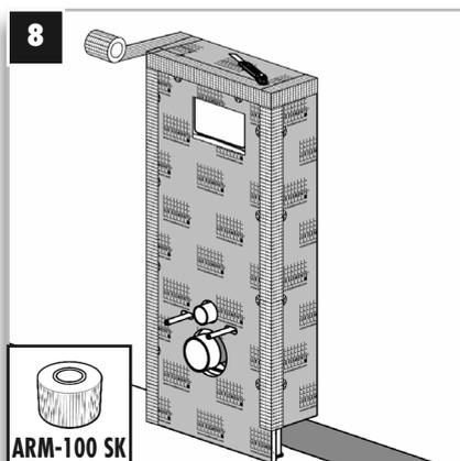
8 Tous les joints et raccords entre les éléments doivent être armés avec la bande d'armature en fibre de verre ARM-100 SK.
