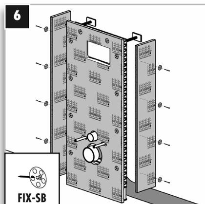
6 ... installation identique des deux panneaux latéraux. Après le collage, fixer les sur le BATI-SUPPORT à l'aide des FIX-SB 45S35.
