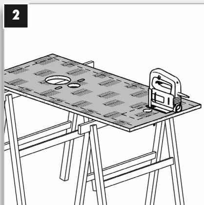
2 Les panneaux - prêt à carreler - ELEMENT, sont à découper de façon appropriée ( y compris la plaque pour le bouton presseur de la chasse à monter ultérieurement ).
