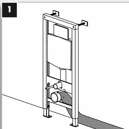
1 Le BATI-SUPPORT forme l'ossature. Lors de l'habillage de celui-ci, il convient également de prendre en considération les recommandations et directives du fournisseur du système.
