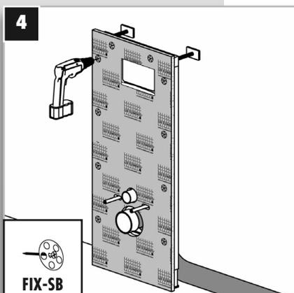
4 Visser à l'aide des FIX-SB 45S35 le panneau sur le BATI-SUPPORT. ATTENTION ! Ne pas visser dans le réservoir !
