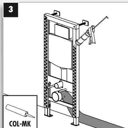
3 Appliquer la COL-MK sur l'ossature métallique du BATI-SUPPORT ainsi que sur les panneaux ELEMENT. Nous vous conseillons d'appliquer en serpentins la colle en cartouche.
